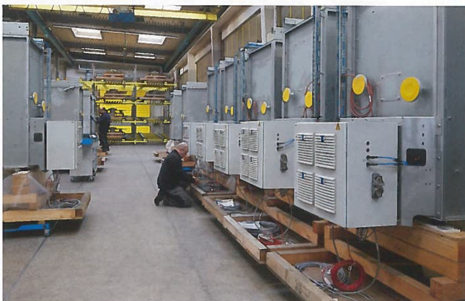
Die Fertigungsstraße Heißluftzeuger für Druckmaschinen
