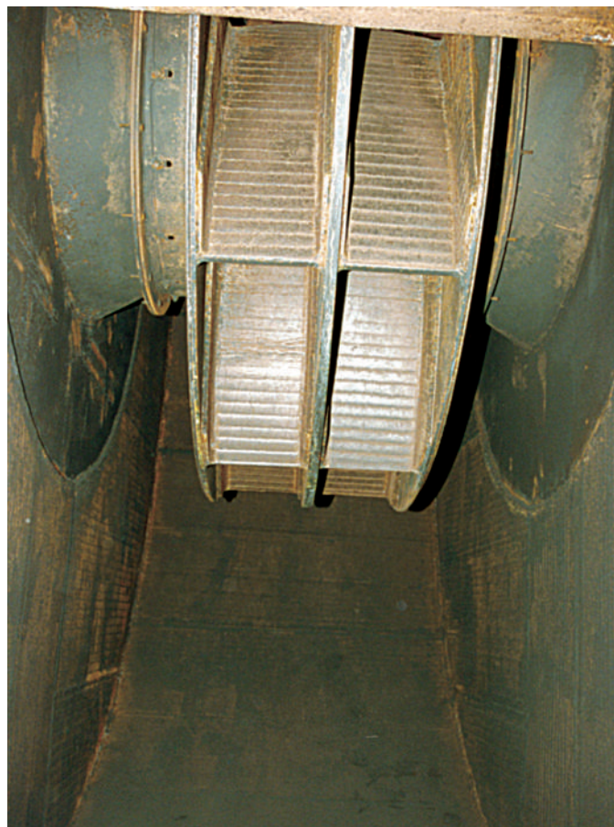
Bild 4: verschleißgeschütztes Laufrad mit entsprechenden Schaufelwinkeln
