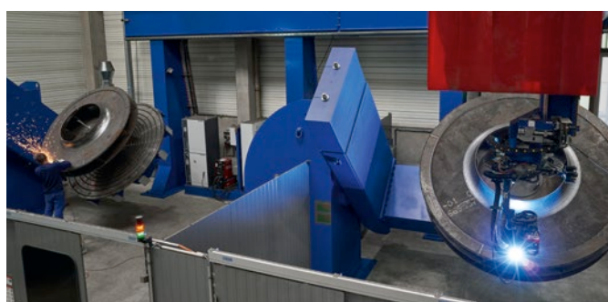
Fünfsachsiger Roboterarm ermöglicht einen effizienten Einsatz in mehreren Schweißstationen
