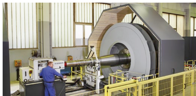
Wuchtbank für Rotoreinheiten bis 5.000 mm Durchmesser
