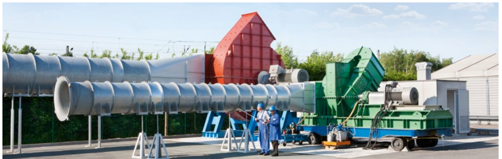
Leistungsprüfstand für Radialventilatoren bis 1.000 KW bei 400 V
