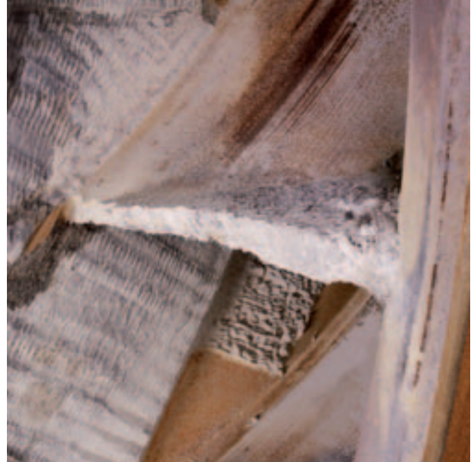
Laufrad aus der Zementindustrie mit Anbackungen und starkem Verschleiß im Schaufeleintrittsbereich sowie auf der Bodenscheibe
