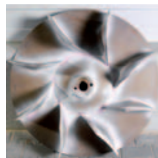
Schadensanalyse/ Rißprüfung mittels Farbeindringprüfung im Bereich Verstärkungskonus – Anbindung zur Bodenscheibe
