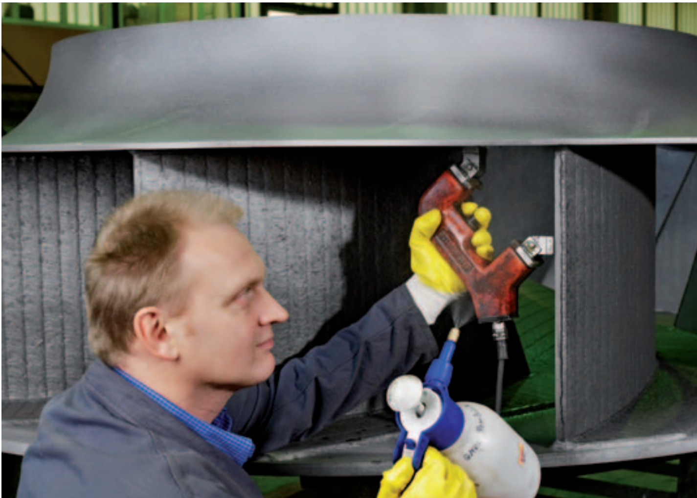
Oberflächenrißprüfung (MP) der Schweißnähte nach ausgeführter Reparatur
