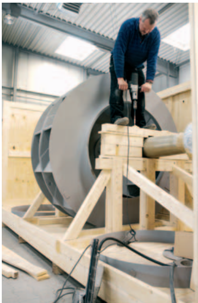
Verpacken des reparierten doppel- flutigen Rotors auf einem Holz- transportgestell für sicheren Transport
