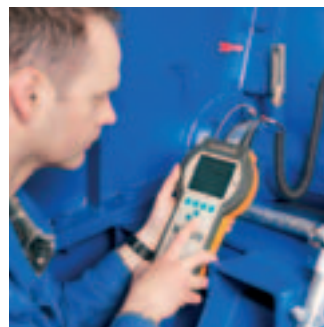
Schwingungsdetektion an einem Laufradlager
