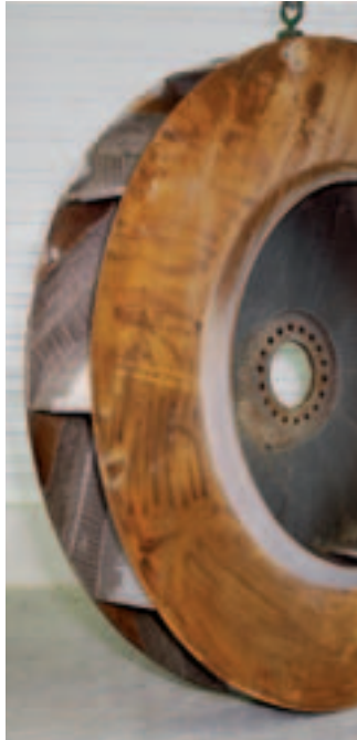
Laufrad aus der Zementindustrie mit Anbackungen und starkem Verschleiß im Schaufeleintrittsbereich sowie auf der Bodenscheibe
