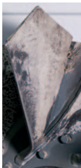
Laufwerk aus der Holzindustrie mit deutlichem Verschleiß, teilweise ab- oder angerissenen Schaufeln
