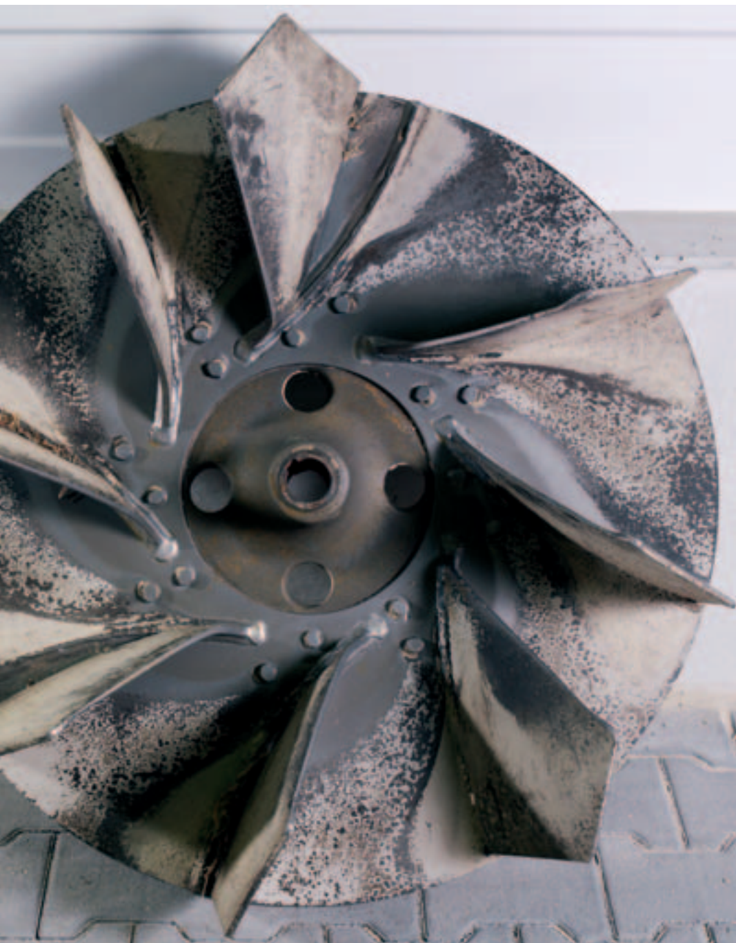
Laufwerk aus der Holzindustrie mit deutlichem Verschleiß, teilweise ab- oder angerissenen Schaufeln
