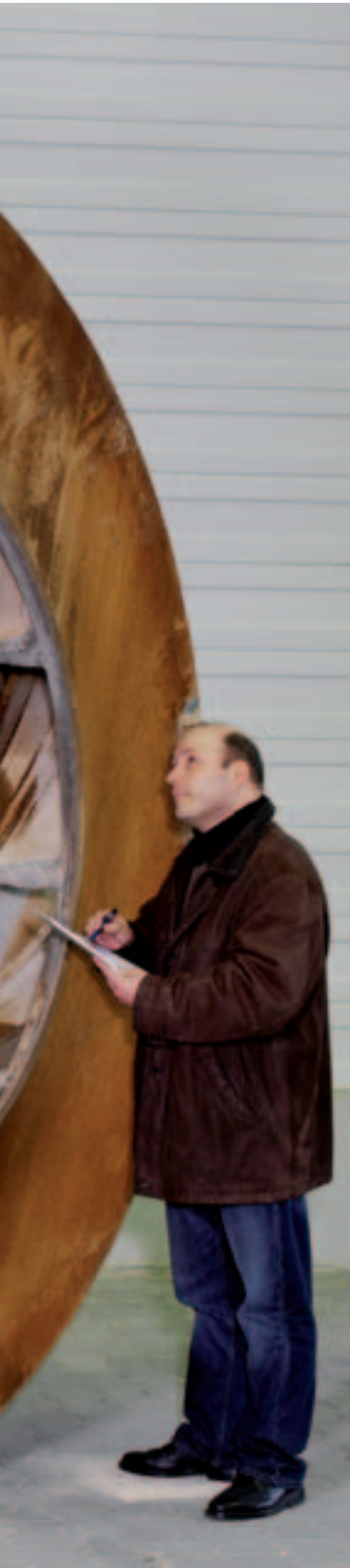
Visuelle Kontrolle des zu reparierenden Laufrades zur Schadensaufnahme und Abgabe eines Kostenvorschlages
