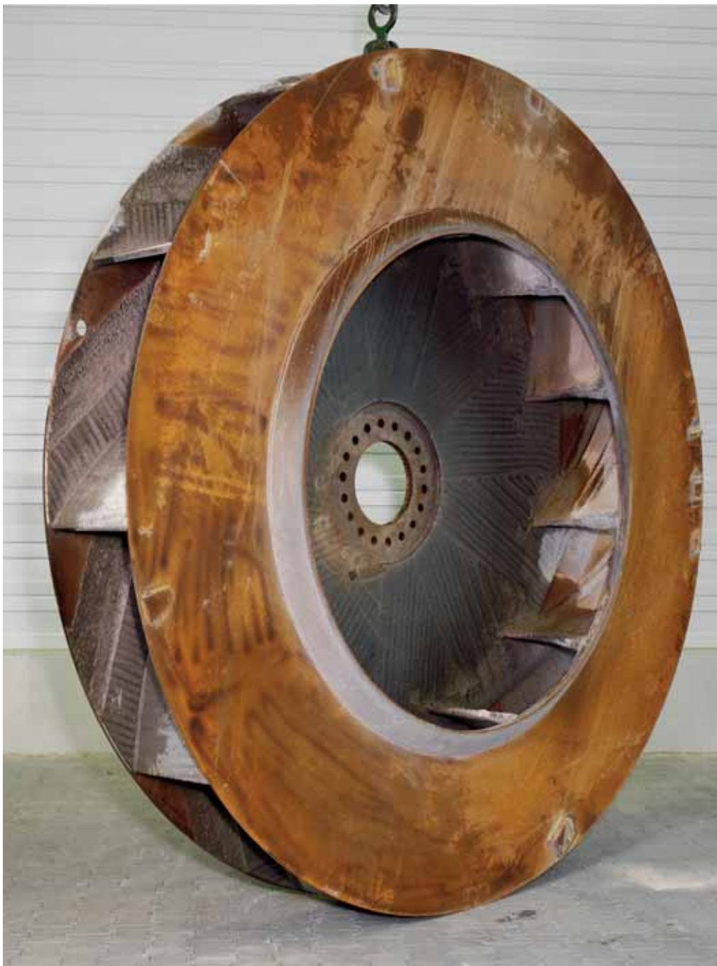
Bild 1 Aufbringung von separaten Verschleißplatten auf Strukturwerkstoff an einem verschlissenen Industrieventilator [2]
