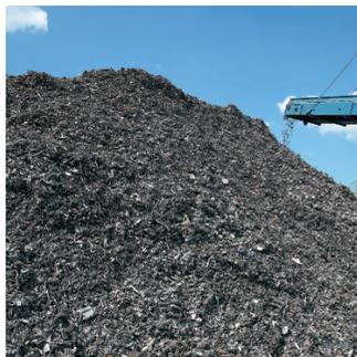
Zum Abwurf der Fe-Fraktion verwenden wir schwenkbare Abwurfbänder, um ein großes Haldenvolumen zu erzielen.
