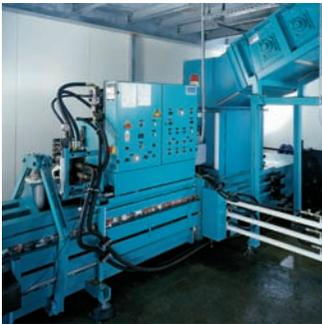
Wir fördern Flaschen und Etiketten vom Entetiketierer zu einer entsprechenden Entsorgungsstelle, wo diese dann verpresst und an einen weiterverarbeitenden Betrieb abgegeben werden können. Gleiches gilt für die Flaschendeckel. Hier sind wir sogar in der Lage, zwei verschiedene Produkte zu erzeugen, die Aluminiumkappen und die PE-Verschlusskappen.
