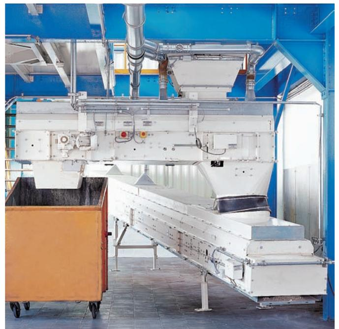
Zur Abscheidung der geförderten Stoffe werden dem jeweiligen Bedarf entsprechende spezielle Abscheider eingesetzt, die je nach Materialart optimal an das abzuscheidende Produkt angepasst sind.
