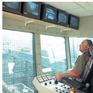
Ein besonderes Beispiel ist die Betriebsweise von Großshredderanlagen. Hier hat Venti Oelde einen wesentlichen Schritt gewagt, indem das reine Steuerpult durch einen Steuerstand ersetzt worden ist, in dem der Shredderfahrer bequem sitzt und alle wesentlichen Prozessdaten ebenso wie die Shredderzufuhr zu jedem Zeitpunkt genau im Auge hat.
