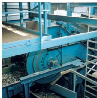
Die Abfallfraktionen werden über automatische Bänder direkt in Container abgeworfen. Alle Bänder im Bereich der Shredderleichtfraktion-Förderung sind abgedeckt und können zusätzlich entstaubt werden.
