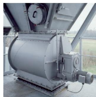
Die von Venti Oelde entwickelte und von der Deutschen Montan Technologie GmbH auf der Bergbau-Versuchsstrecke geprüfte druckstoßfeste und zünddurchschlagsichere Zellenrad schleuse stellt eine brandschutztechnische Trennung, z. B. zwischen Filteranlage bzw. Abscheider und der nachfolgenden Fördertechnik, sicher. Die Ausführung entspricht den anzuwendenden Normen und Richtlinien nach dem Stand der Technik.
