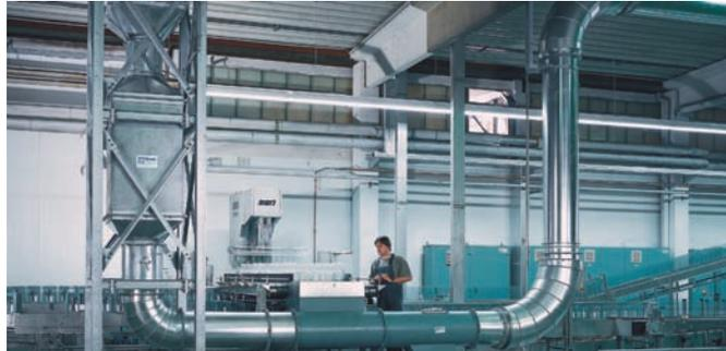
In der Lebensmittelindustrie wird Hygiene groß geschrieben. Für die Getränkeindustrie beispielsweise entsorgen wir die PET-Flaschen mit unserer im Saugbetrieb arbeitenden PET-Flaschen-Förderanlage. Ein Austreten von Restflüssigkeiten oder verunreinigter Luft aus dem Fördersystem ist somit ausgeschlossen.
