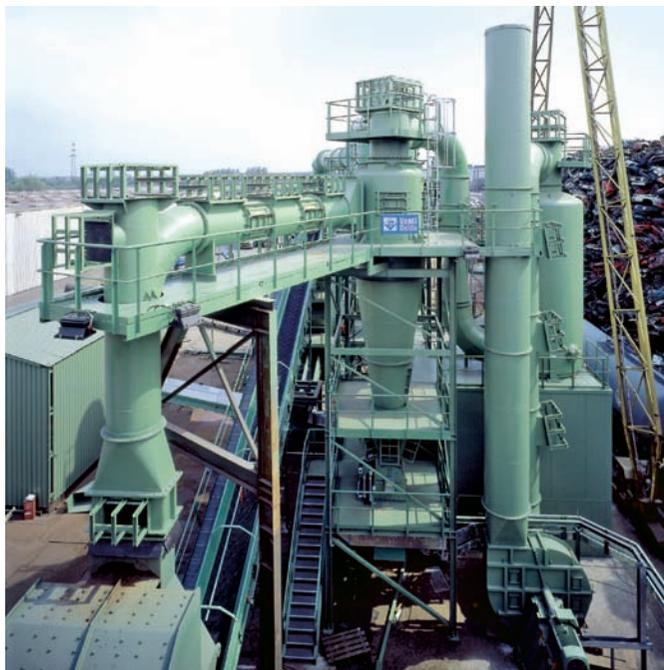
Umluftwindsichter zur Reinigung des Metallschrottes, im wesentlichen Fe, werden bei großen Durchsatzmengen bis zu 200 t/h eingesetzt. Die Luft wird zu ca. 90 % im Umluftbetrieb gefahren. Das Ergebnis ist ein qualitativ hochwertiger Fe-Schrott und eine geringe Belastung der Umwelt durch deutlich verminderte Abluftvolumenströme und Staubfrachten.
