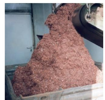
Egal ob Abfälle mechanisch-biologisch vorbehandelt oder verbrannt werden, sinnvoll ist eine Störstoffabtrennung in jedem Fall. Hierfür bietet Venti Oelde eine Vielzahl von verschiedenen Lufttrenntechniken, die sogenannten Sichter, an. Diese zeichnen sich durch Umluftbetrieb sowie durch die Verarbeitung großer Durchsätze aus. Neuentwicklungen wie der Grobgutabscheider runden die Angebotspalette ab.
