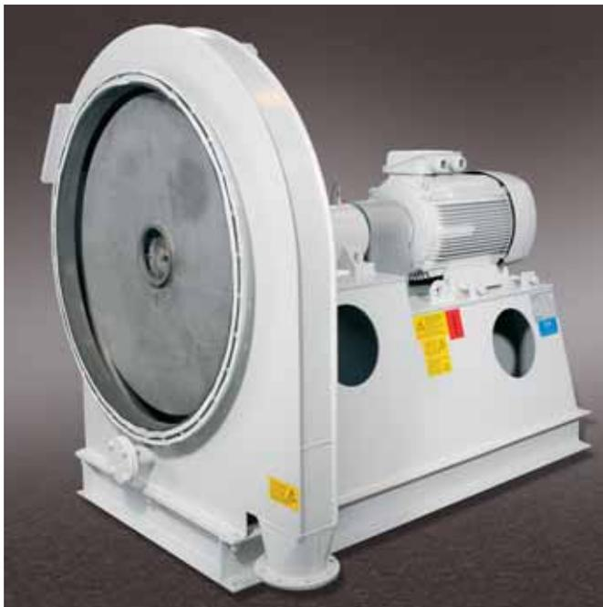
Um Stahlbleche zu entzundern, wird in Beizanlagen Salzsäure eingesetzt. Unsere Röstgas-Ventilatoren führen die ätzenden Säuredämpfe wieder ab. Sie sind korrosionsresistent. Das Gehäuseinnere ist mit extrem widerstandsfähigem Hartgummi beschichtet, die Laufräder sind aus Titan gefertigt.
