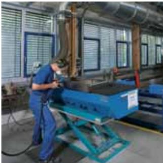
Schweißrauchabsaugungen erfassen Gase punktuell am Objekt oder über große Hauben. Die abgesaugten Gase werden über eine Sammelleitung dem Filtersystem zugeführt. Luftvolumen von bis zu 150.000 m<sup>3</sup>/h werden so ausgetauscht.
