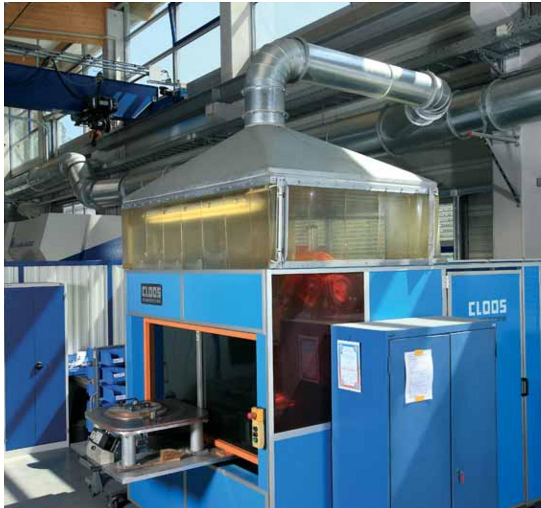
Zusätzlich besteht die Möglichkeit, die Wärmeenergie aus der Fortluft über ein Wärmerückgewinnungssystem zu nutzen. Die Prozesswärme wird durch einen Rotovent-Wärmetauscher mit hohem Wirkungsgrad zurückgewonnen, die Frischluft wird über intelligente Luftrückführsysteme in den Arbeitsbereich geleitet. Damit senken wir die Betriebskosten, erhöhen die Produktivität und optimieren die Arbeitsabläufe.
