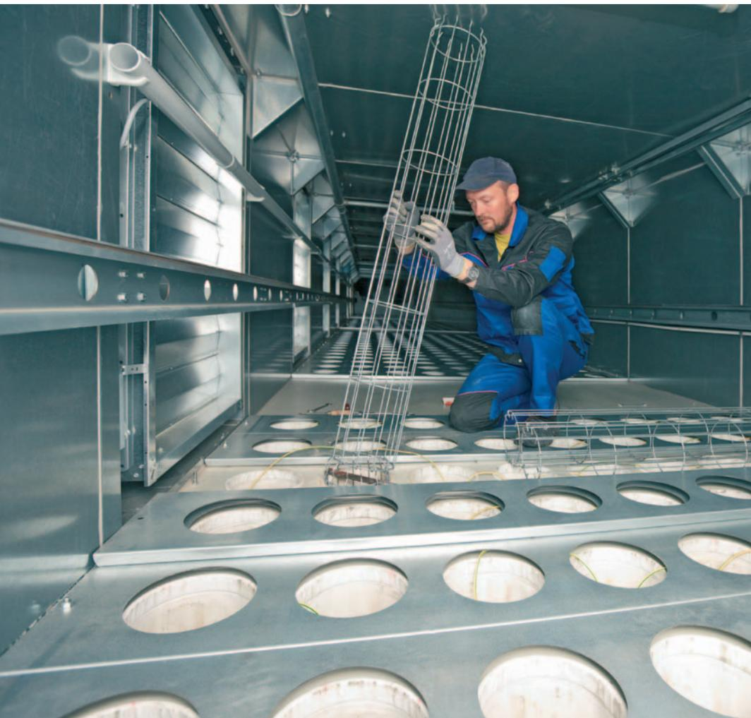
neten Heißgasfiltermedium aus. Mit konstruktiven Maßnahmen berücksichtigen wir die starke Wärmeausdehnung. Die Filter werden bedarfsgerecht wärmeisoliert oder gegebenenfalls beheizt.
