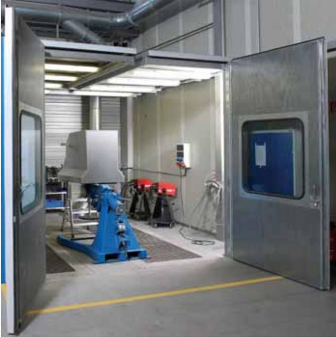
Arbeitschutzkabinen sind ideal, um angrenzende Arbeitsplätze gegen Staub- und Lärmbelastigungen abzuschirmen. Sie bestehen aus dem Kabinenteil in offener oder geschlossener Ausführung. Die Wände und Türen sind mit hochwertigen Schalldämmkullissen ausgestattet. Hochleistungs-Radialventila-
