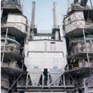
Venti Oelde fertigt seine Industriefilter je nach Anforderung in verzinkter, lackierter oder Edelstahlausführung – immer mit einer Mindestgehäusewandstärke von 3 Millimetern. Die extrem robusten Ausführungen bewähren sich täglich in zahlreichen Industriezweigen, etwa in der Stein-/Erdenindustrie, der Holzindustrie, in der Metallbe- und -verarbeitung sowie im Recycling.
