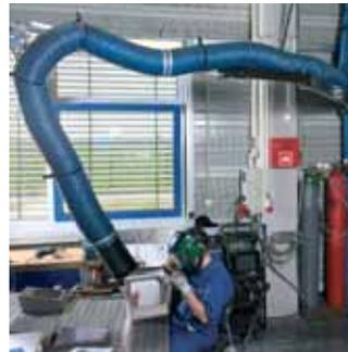
Schweißrauchabsaugungen erfassen Gase punktuell am Objekt oder über große Hauben. Die abgesaugten Gase werden über eine Sammelleitung dem Filtersystem zugeführt. Zusätzlich besteht die Möglichkeit, die Wärmeenergie aus der Fortluft über ein Wärmerückgewinnungssystem zu nutzen.
