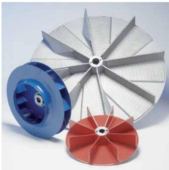
Venti Oelde setzt speziell ausgebildete Laufräder ein, um das Material durch ein optimiertes Rohrleitungsnetz zum Filter bzw. Container zu fördern. Bei abrasivem Fördergut beugt Venti Oelde dem Abrieb durch Prall- und Gleitverschleiß in Form von Hartauftragsschweißung mit Wolfram- oder Chromcarbiden vor.
