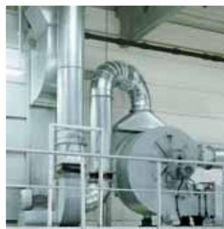
Zur Vorabscheidung unterschiedlicher grober Materialien aus dem Luftstrom hat Venti Oelde den Grobgutabscheider entwickelt. Er ermöglicht einen kontinuierlichen Betrieb und Materialaustrag. Die abgesaugte Luft wird in der nachgeschalteten Filteranlage gereinigt.
