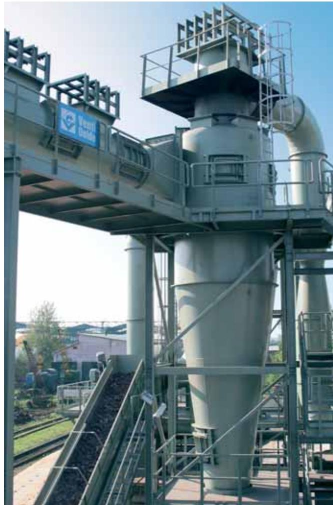
Für kundenspezifische Einzelösungen bietet Venti Oelde Zyklone aus verschiedenen Werkstoffen in hochfester Bauweise an. Je nach Bedarf werden sie druckstoßfest oder auch verschleißgeschützt ausgeführt.
