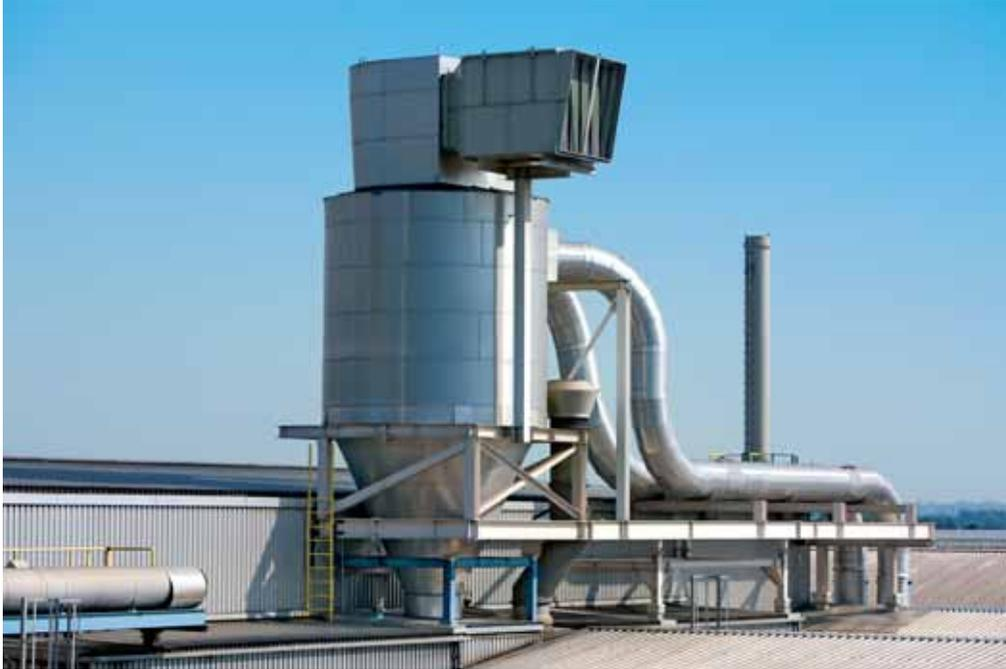
Heute setzen wir Zyklone vorwiegend bei hohem Materialanfall als Vorabscheider für Absaug- und Filteranlagen oder auch zur Funken- und Tropfenabscheidung ein. Sie arbeiten ohne zusätzliche Abreinigungstechnik durch Fliehkraftabscheidung, sind funktionssicher, wartungsarm und unempfindlich bei unregelmäßigem Materialanfall. Sie sind für ihre robuste Betriebsweise bekannt.
