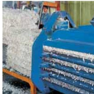
Die ausgetragenen Abfälle werden in Ballen- oder Containerpressen verdichtet. Staub aus Filteranlagen wird in Big Bags gesammelt oder zu Briketts und Pellets verpresst.
