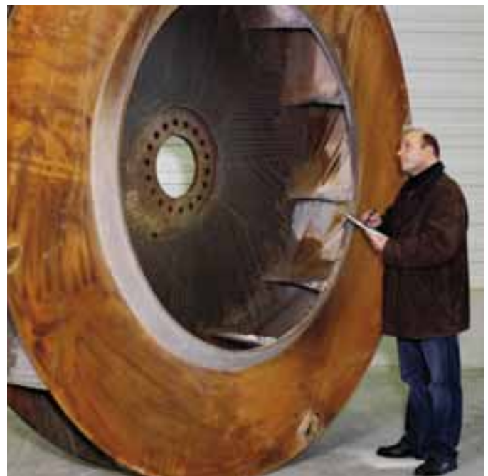
Erste Sichtprüfung und Aufnahme eines Schadensprotokolls
