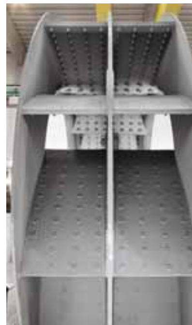
Schraub-/Schweißverbindung der Verschleißschutzplatten am Laufrad
