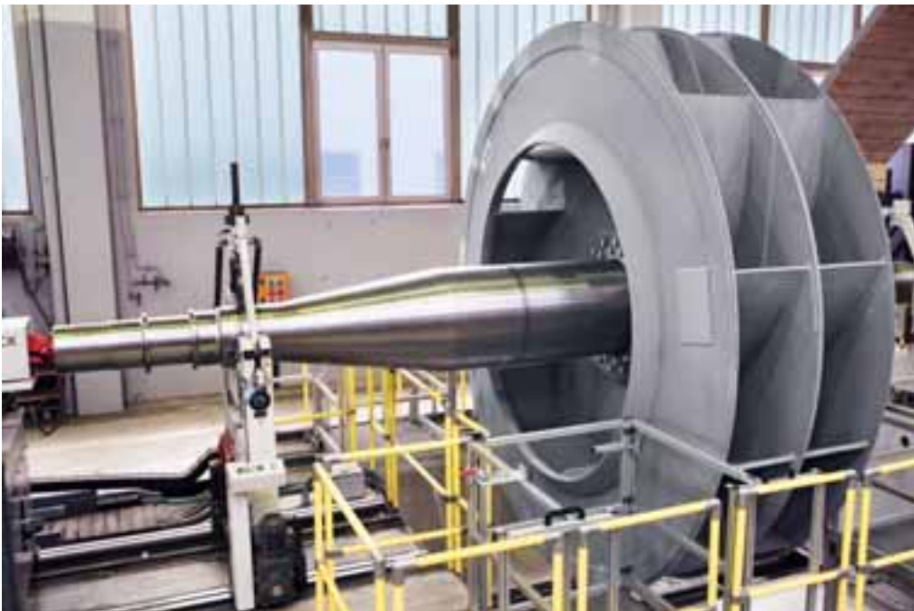
Auswuchten eines doppelflutigen Rotors
