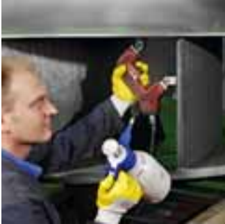
Oberflächenrissprüfung (MP) der Schweißnähte nach ausgeführter Reparatur
