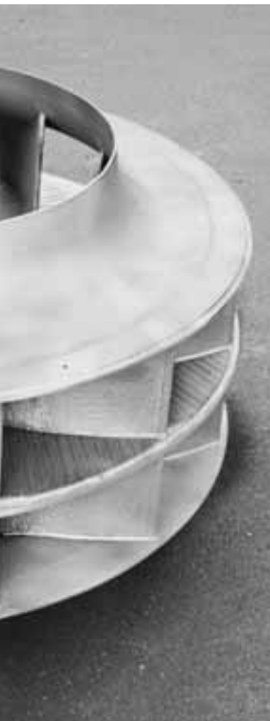
Lauftrad mit komplett verschweißtem Verschleißschutz
