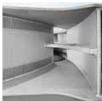
Kombination verschiedener Verschleißschutzmaterialien auf der Lauftradschaufel
