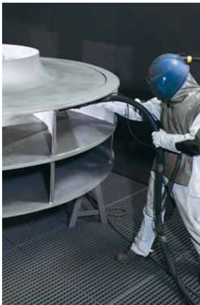
Reinigung eines zweiflutigen Laufrads zur Schadensanalyse
