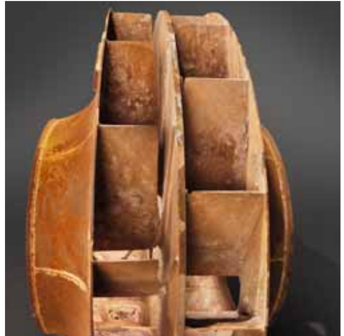
Beschädigtes Laufrad ohne Verschleißschutz
