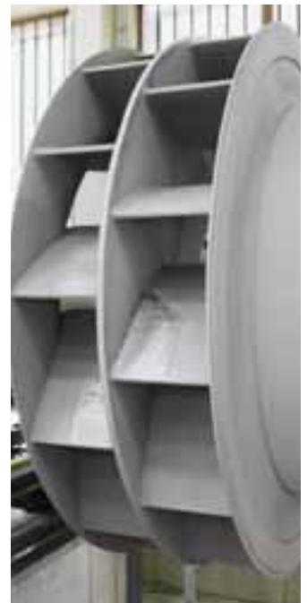
Gezielter Verschleißschutz auf Bereichen der Laufradschaufel
